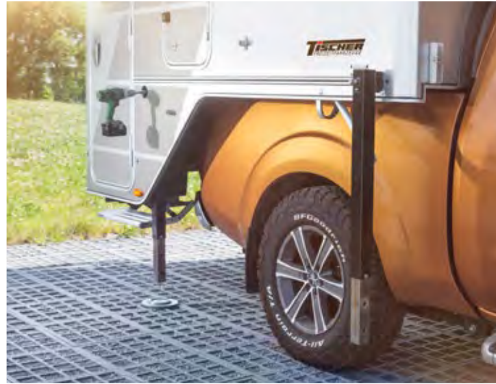
Stützen ausfahren mit Akkuschauber oder Kurbel
