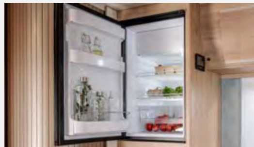
Kompressorkühlschrank, 85 l mit Gefrierfach
