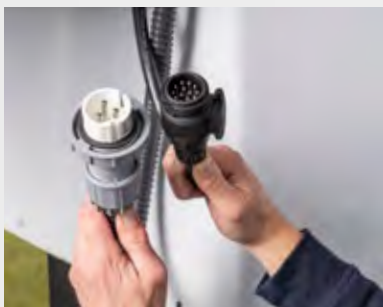
13-poliger Stecker für Beleuchtung und 3-poliger Hochstromstecker für Batterieladung
