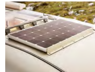
120 Watt-Solaranlage, Ladestromregler (Standardausstattung: 1 x 120 Watt-Solarpanel)
